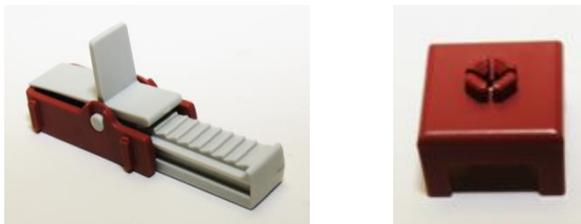
Le système est livré avec un ressort démontable et un support carré pour être monté sur le rail. (Ce support peut être réutilisé pour l'expérience sur l'équilibre statique, pour constituer un point d'accroche sur le rail).
