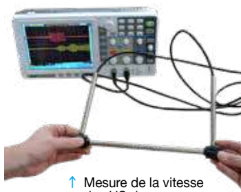
Mesure de la vitesse ↑ des US dans l'eau
