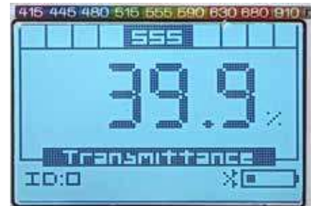
Mesure de l'absorbance ou de la transmittance à la longueur d'onde sélectionnée
