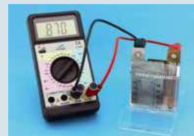
Réalisation d'une pile
