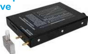
Boîtier métallique plat avec graduation intégrée des longueurs d'ondes pour une détermination grossière de la longueur d'onde de raies spectrales. Tableau de correspondance des éléments chimiques inscrit sur le boîtier
