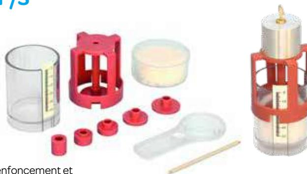
Mesurer précisément l'enfoncement et donc la pression exercée en fonction de la surface d'appui sur une matière floconneuse spéciale semblable à de la neige, très sensible à la pression. Les surfaces d'appui sont interchangeables et calibrées pour maintenir la masse du système pressant constante. L'échelle est graduée au 1/2 mm, avec le 0 ajustable exactement au niveau de la surface pour mesurer précisément l'enfoncement.
