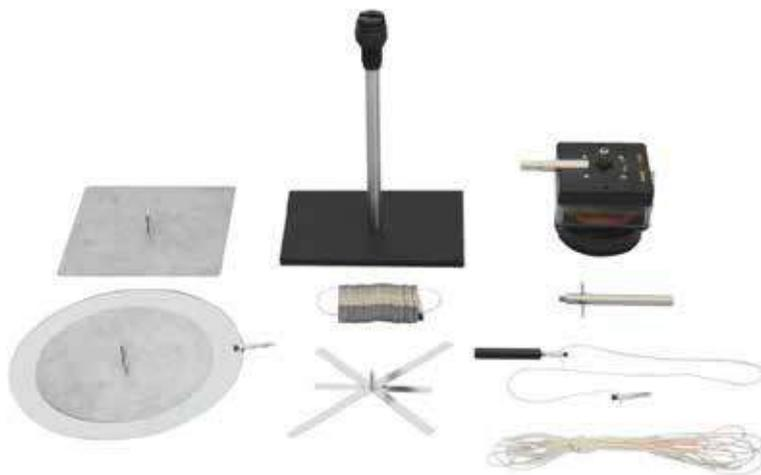
Alimenté par un générateur de fonctions basses fréquences amplifié (non fourni), ce vibreur permet de générer des vibrations de fréquence variables de 0 à 20 kHz. Il peut être monté sur son support verticalement ou horizontalement, pour réaliser tout type d'expérience de vibration.
