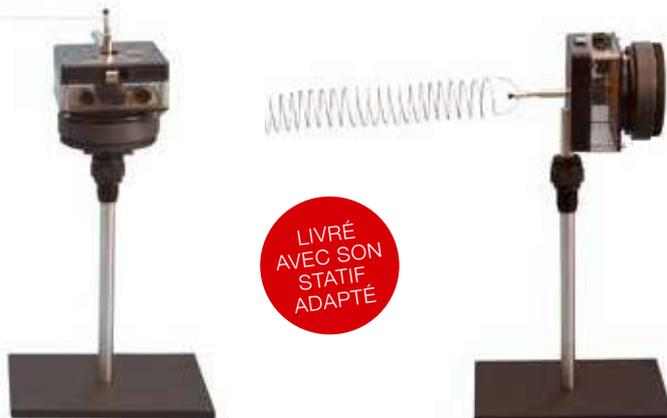
Alimenté par un générateur de fonctions basses fréquences amplifié, ce vibreur permet de générer des vibrations de fréquence variables de 0 à 20 kHz. Il peut être monté sur son support verticalement ou horizontalement pour réaliser tout type d'expérience de vibration : corde, ressort, plaques ou lamelles vibrantes, anneau...
