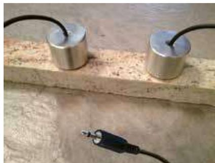
Ces capteurs piézoélectriques captent essentiellement les vibrations mécaniques qui se transmettent dans les matériaux solides (ils sont très peu sensibles au bruit ambiant).
