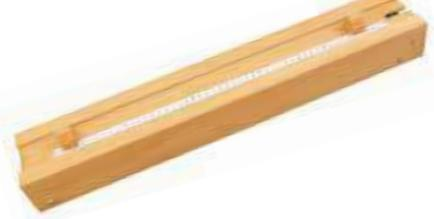
Une corde unique tendue sur une caisse de résonance en bois graduée sur 500 mm.
