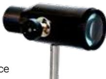
LED blanche puissance lumineuse 30 à 40 W, avec réglage de focalisation par crémaillère (pour concentrer plus ou moins le faisceau) et condenseur, sur tige courte. Livrée avec alimentation 5 V et objet dépoli magnétique.
