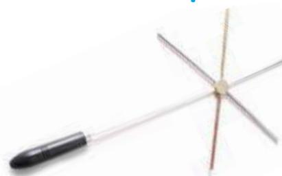
Étoile avec 5 branches métalliques : cuivre, laiton, fer, aluminium et nickel pour montrer la vitesse de propagation de la chaleur dans différents métaux.
