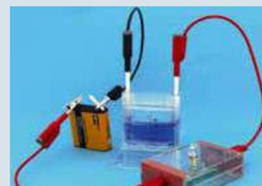
Mesure de conduction dans les liquides
