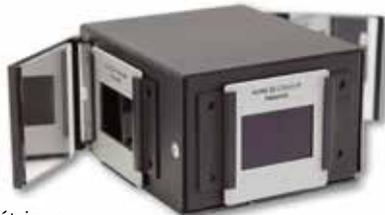
Source polyvalente pour l'étude de l'optique géométrique et de la synthèse additive des couleurs (à l'aide des filtres diapositives de couleur 50 x 50 mm à commander séparément réf. 004 099 et réf. 004 107). Sa semelle magnétique permet une utilisation verticale sur panneau magnétique.
