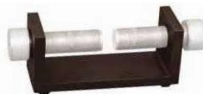
2 aimants néodyme sont fixés au bout de 2 tiges filetées pour ajuster très précisément et confortablement le champ magnétique entre les 2 aimants.
