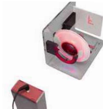
Lettre F composée de 12 LED alimentées par un adaptateur secteur (fourni), simulant un objet à l'infini.
