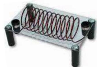
Utilisation avec du fer en poudre ou une aiguille aimantée. Base transparente pour visualisation sur rétroprojecteur.
