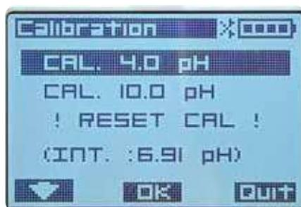
Calibration sur solutions étalons pH 4 et pH 10
