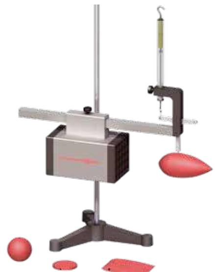
Dispositif d'étude des lois de l'aérodynamique. Compact, il se fixe sur un statif (non fourni) directement sur la paillasse de l'élève. Doté d'une soufflerie silencieuse, il peut être utilisé sur plusieurs postes élèves en même temps. Il permet d'étudier l'influence de la forme d'un solide sur sa résistance aérodynamique (trainée) et de vérifier que la résistance aérodynamique est proportionnelle au carré de la vitesse d'écoulement de l'air.
