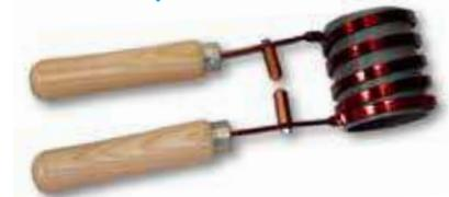
5 spires Ø 60 mm, 2 poignées en bois et 2 contacteurs en cuivre pour réaliser l'expérience de la soudure par point à l'aide du transformateur ci-dessus.
