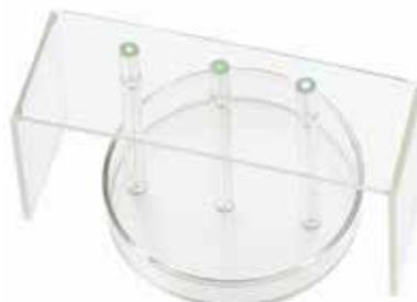
3 tubes capillaires en verre de diamètres internes de 1 à 3 mm sont fixés sur un support en plexiglas.
