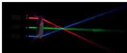
Ce kit est composé de 3 sources LED (rouge, vert et bleu) montées sur boîtier magnétique avec interrupteur. Chaque source LED peut fournir un faisceau faiblement divergent pour la synthèse des couleurs ou un faisceau trait (à l'aide de son accessoire fourni) pour l'étude de la réflexion et de la réfraction. Livré avec piles LR6, sans accessoire d'optique.
