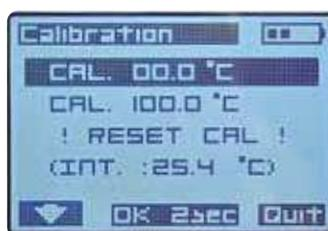
Calibration sur des grandeurs physiques étalons 0°C et 100°C.
