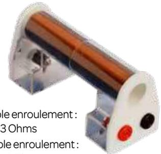
Sortie simple enroulement : 500 spires 3 Ohms
