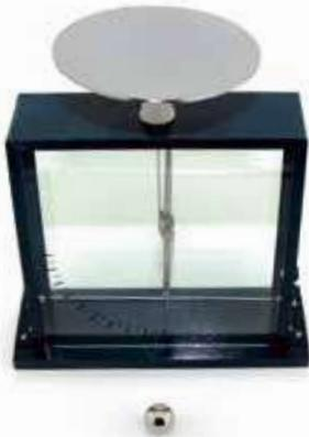
En présence de charges l'aiguille de l'électroscope pivote.
