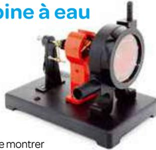
Permet de montrer la conversion de l'énergie mécanique en énergie électrique en utilisant une turbine à eau qui entraîne une dynamo. Le modèle est constitué d'une roue placée dans une enceinte avec une façade en plexiglas permettant de visualiser son fonctionnement. L'eau est introduite par un raccord cannelé placé au-dessus de la turbine. Une LED permet de constater la conversion de l'énergie mécanique en énergie électrique.
