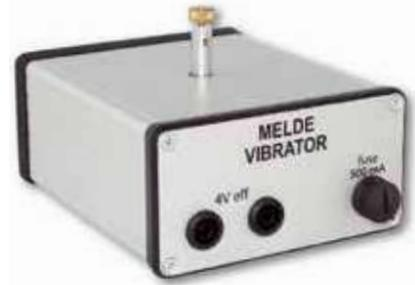
Dispositif très compact constitué d'un haut-parleur robuste, dont la membrane assure la transmission de la vibration à un axe positionné en son centre.
