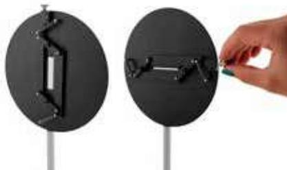
Une vis moletée permet d'ajuster en continu et en simultanément l'écartement de 0 à 9 mm. Un ressort de rappel est présent pour éviter les jeux.
