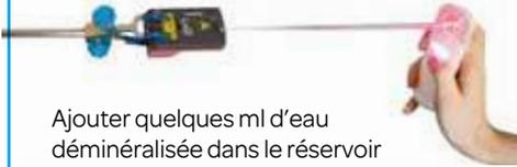
Ajouter quelques ml d'eau déminéralisée dans le réservoir et générer une brume qui permettra de diffuser la lumière d'un faisceau laser et ainsi le rendre visible.
