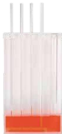
4 tubes capillaires 250 mm en verre de diamètres internes différents sont placés sur un support en plexiglas avec cuve intégrée et tube de remplissage.
