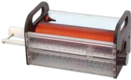
Equippée de 2 poignées de transport. Echelle graduée en cm et en Henri des deux côtés permettant une lecture dans les deux sens. La position du noyau de fer doux couissant dans la bobine au moyen d'une vis sans fin est indiquée par un index rouge.
