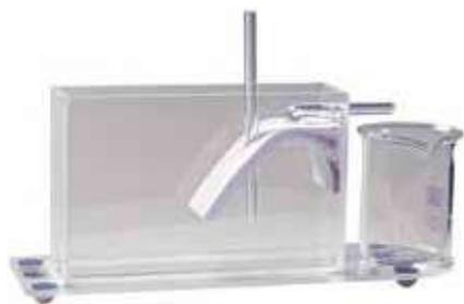
Maquette analogique pour l'étude du fonctionnement d'un piège pétrolier.
