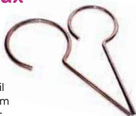
Anneaux en fil d'acier Ø 7 mm chromé. Pour entonnoirs et ampoules à décanter.
