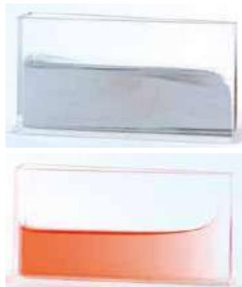
Cuve en plexiglas en forme de prisme, angle de  $10^\circ$ , pour montrer le phénomène de capillarité et la tension de surface des liquides.
