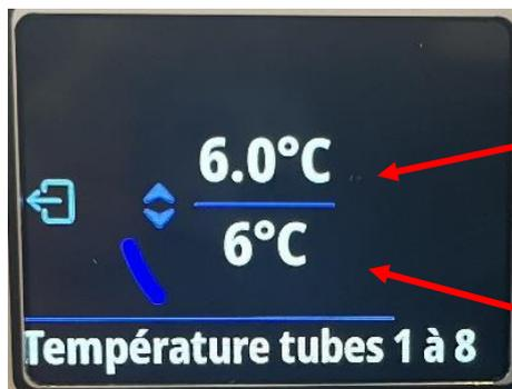
*Température mesurée dans les supports de tubes*
