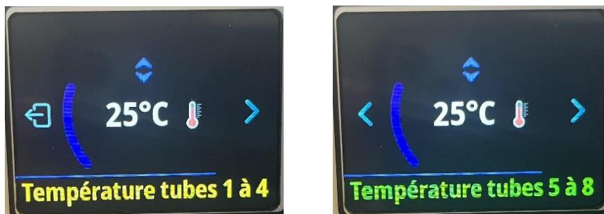
Réglez la température des tubes 5 à 8 de la même manière que pour température des tubes 1 à 4 et réappuyez sur la flèche de droite pour sortir du mode du réglage.
